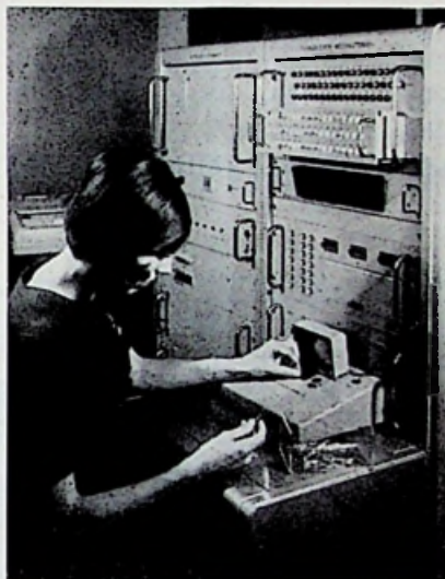
Nieuw halfgeleider-meetapparaat voor snelle metingen of controle van de belangrijkste halfgeleider parameters.
